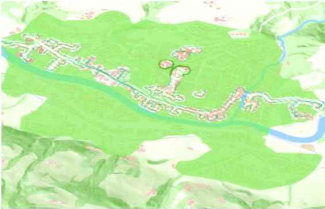
© SAGIS Der Kartenausschnitt zeigt ein bestehendes Wärmenetz mit dem Bereich, in dem weitere Anschlüsse möglich sind (Verdichtungsgebiet; grün) und jenem Bereich, der aufgrund der Wärmenachfragedichte grundsätzlich für eine Erschließung mit dem Wärmenetz geeignet wäre (potenzielles Erweiterungsgebiet; schraffiert).
